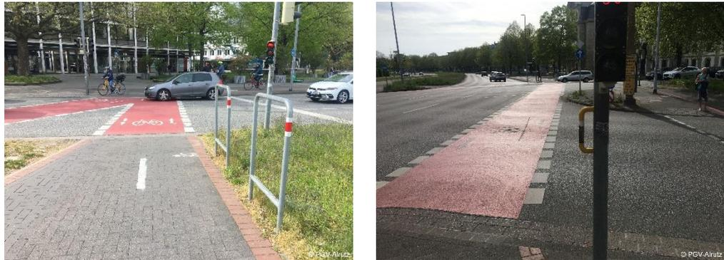
Abb. 6-4: Beispiele für Haltegriffe und -bügel aus der Region Hannover
