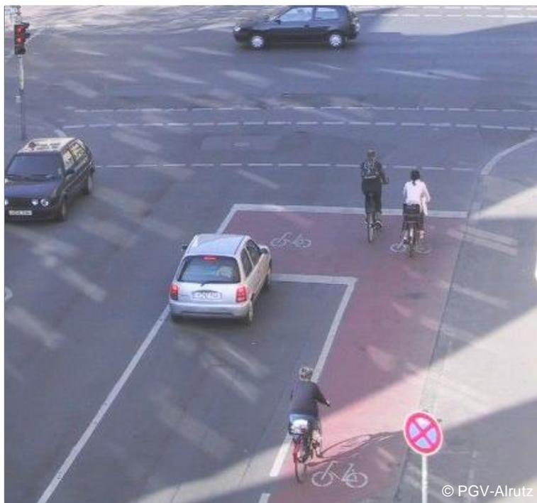
Abb. 4-20: Aufgeweiteter Radaufstellstreifen (ARAS) (Hannover)
