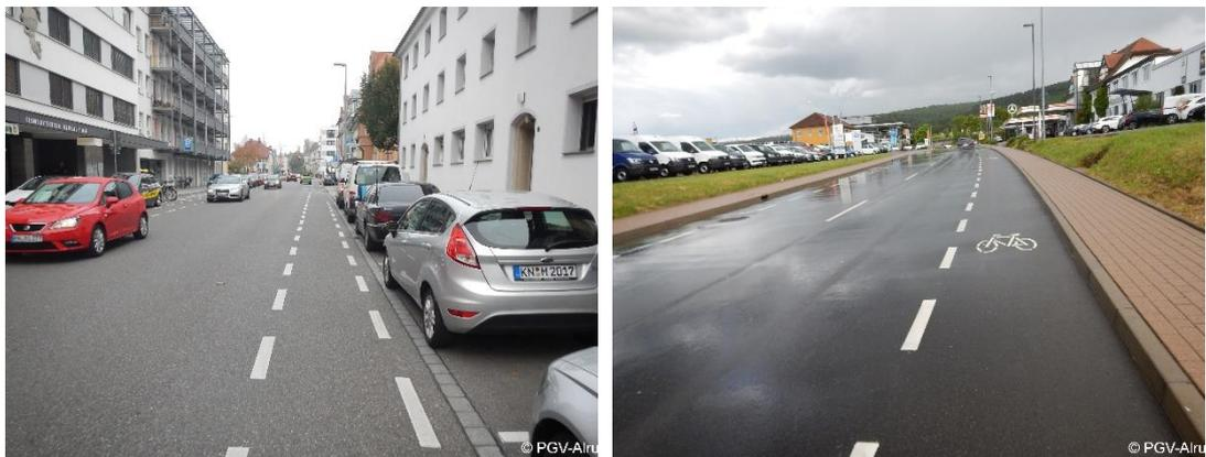
Abb. 4-12: Links: Schutzstreifen (in Mindestbreite gemäß ERA 2010) mit Sicherheitstrennstreifen zu parkenden Kfz (Singen);
