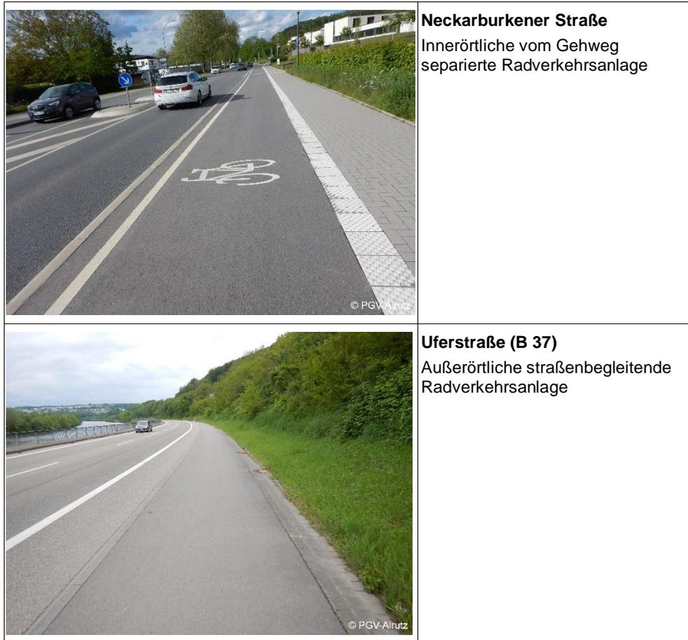
Abb. 2-4: Positive Beispiele der Radverkehrsführung in Mosbach
