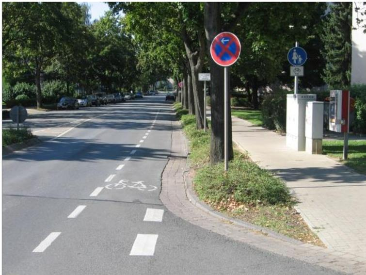
Abb. 4-13: Kombination von Schutzstreifen mit Gehweg, Radverkehr frei (Hameln)
